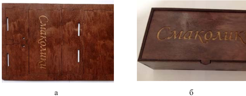
Рис. 4. Приклад коробки (заготовка покрита морилкою і лаком): а – деталі виробу; б – загальний вигляд виробу
